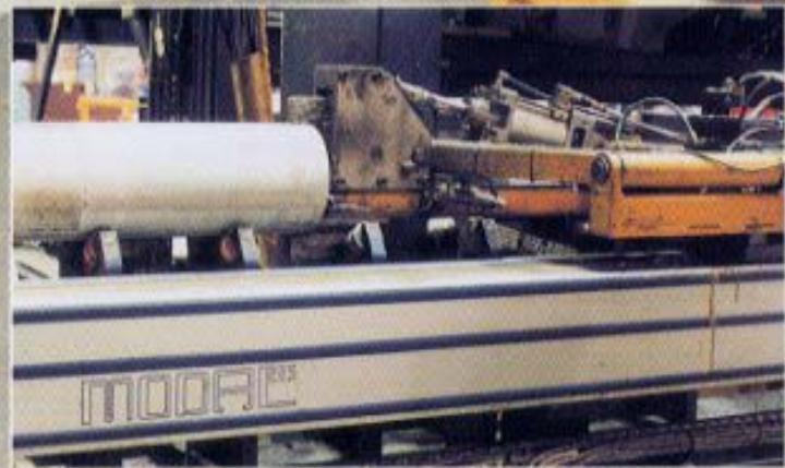
Hos **SAPA** i Finspång har en ökad automatisering av processen, strängpressning, lett till att ämnet till pressen numera laddas med hjälp av en Modal linjärenhet och portalrobotar. Linjärenheten - Modal TLE 225 - matar fram utgångsmaterialet till en kaputrustning, där den rätta längden på ämnet kapas till.
